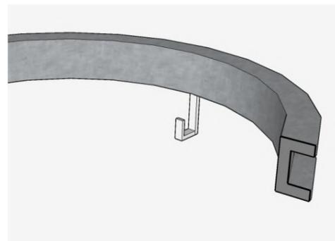
3 вариант – оснащение существующей урны дополнительной системой закрывания с крючками для мусорных мешков (предохранение от выдувания мусора и от птиц)
