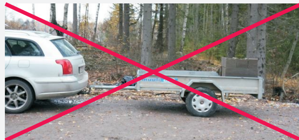
Рисунок 3. Центр тяжести груза смещён назад
