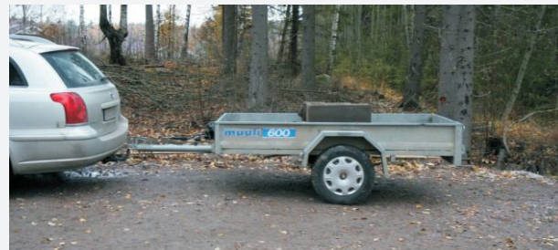
Рисунок 1. Центр тяжести груза расположен правильно
